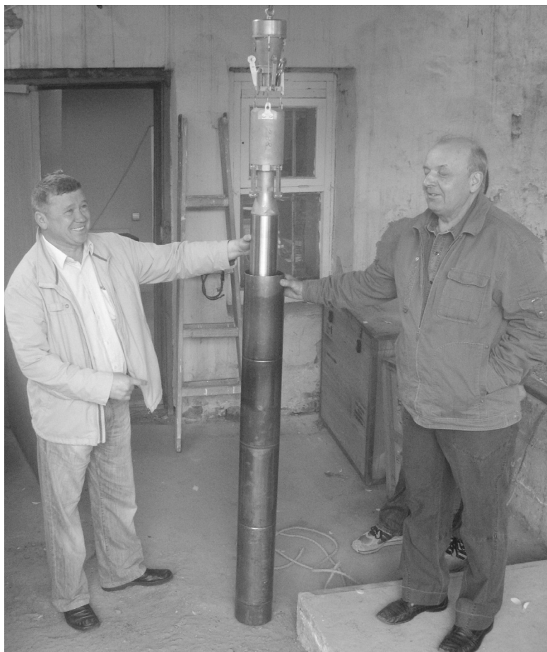
Рис. 4. Сейсмоприемник в системе установки в скважину
